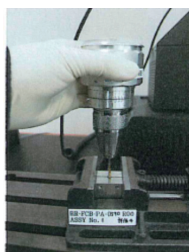
(図7) アバットメントスクリューのねじり強度試験 (n=5)
