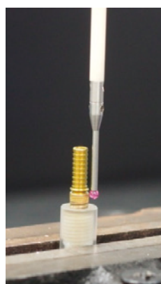
図3 BLインプラントへのアバットメント締結に伴う沈下量の計測方法と結果 トルクゲージBTG36CN (株東日製作所製)を使用し、NPアバットメントに20N・cm、RPならびにWPアバットメントに30N・cmでスクリューを締結し、三次元計測機 Crysta-Apex C574 (株ミットヨ製)で、沈み込み量を計測。
